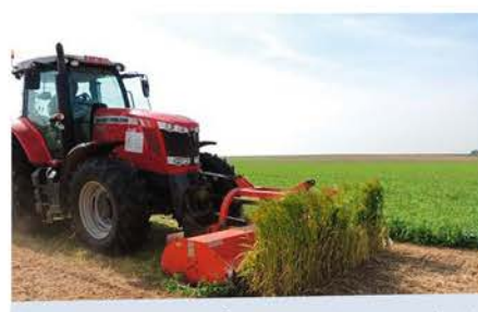
Broyeur à marteaux, broyé non incorporé (BNI)
